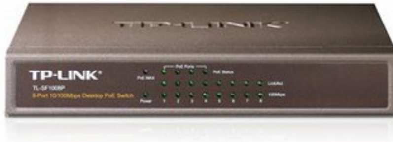
Obrázek 6. Použitý Ethernetový switch s podporou Power over Ethernet
